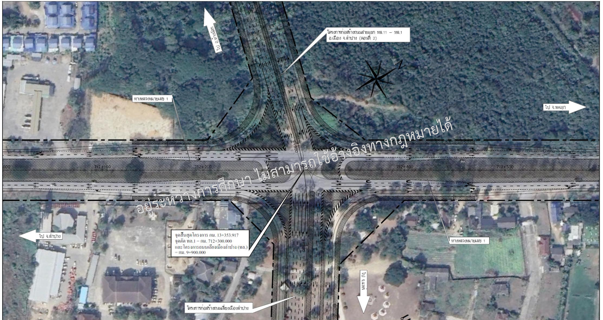
รูปที่ 9-12 แบบขยายจุดตัดทางแยกระดับพื้นปรับปรุงเป็นแยกสัญญาณไฟจราจร
